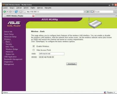
**NÁZEV SÍTĚ:** Změnit SSID a schovat access point může být při výběru vhodného zařízení opravdu snadné.
